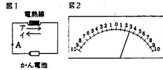
実験2 図1と同じかん電池をいくつか用意し，図3，図4のように，図1の回路に，かん電池を2個，3個と直列につないでいき，A点を流れる電流の強さを検流計で調べた。表1はその結果を示している。
